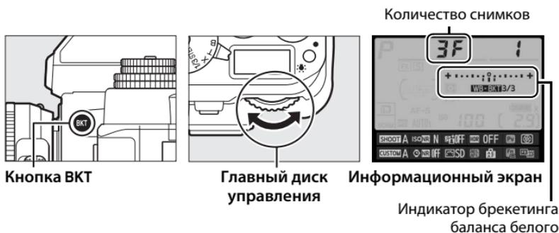
При настройках, отличных от **CF**, **ВКТ** и **ВКТ** отображаются соответственно на панели управления и в видоискателе; символ **WB-ВКТ** и индикатор брекетинга появляются на информационном экране.
