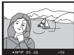
кадров, если спусковая кнопка затвора удерживается нажатой наполовину (**AF-S**) или удерживается нажатой кнопка <sup>AE-L</sup><sub>AF-L</sub> «**AE-L/AF-L**» (**A3-B/A3-B**), что позволяет сделать последовательно несколько фотографий при одинаковой настройке фокусировки.
