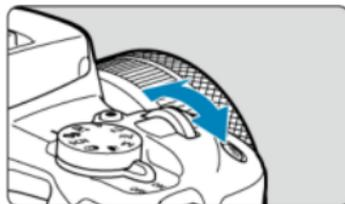
Нажмите кнопку, например < ISO >, затем поворачивайте диск <
