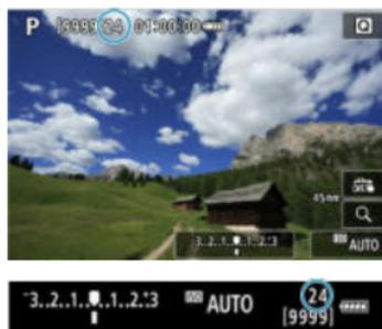
Соответствующая максимальная длина серии отображается в левом верхнем углу экрана съемки и в правом нижнем углу видеодискетеля.
