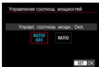
При использовании вспышки в режиме макросъемки можно задать управление соотношением мощностей. Подробные сведения об управлении соотношением мощностей вспышек см. в инструкции по эксплуатации вспышки в режиме макросъемки.
