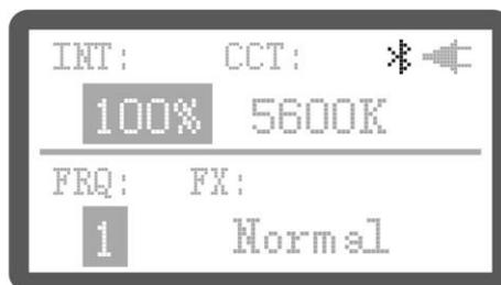
Нажмите и удерживайте кнопку Reset в течение 3 секунд. В правом верхнем углу OLED-дисплея появится мигающий значок Bluetooth и произойдет сброс всех ранее сопряженных устройств. Процесс завершится в течение нескольких секунд и значок Bluetooth погаснет.
