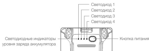
Во время зарядки и разрядки индикаторы уровня заряда показывают текущий уровень заряда аккумулятора. Состояния индикаторов определяются следующим образом:
