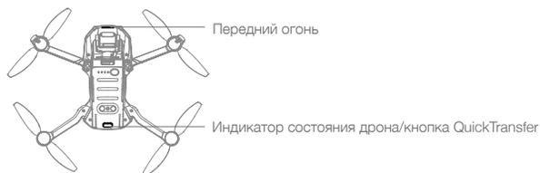
Передний огонь обозначает расположение дрона и мигает, когда дрон включен.
