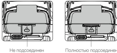
Нажмите на зажим аккумулятора и отсоедините его от отсека, чтобы извлечь.
