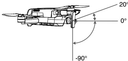
Управлять наклоном камеры можно при помощи колесика наклона камеры на пульте управления. Кроме того, в DJI Fly можно зайти в режим вида с камеры. Нажимайте на экран до появления кружка, затем перетасщите его вверх или вниз для изменения наклона камеры.
