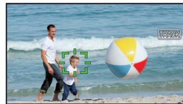
\* Рамка слежения мигает красным цветом, а затем гаснет примерно через 3 секунды. Режим слежения продолжит действовать, если до отключения рамки слежения будет выполнено обнаружение объекта или касание другого объекта.
